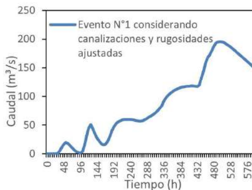
Figura 5: Hidrograma en punto de cierre obtenido de la simulación calibrada del Evento N° 1.
