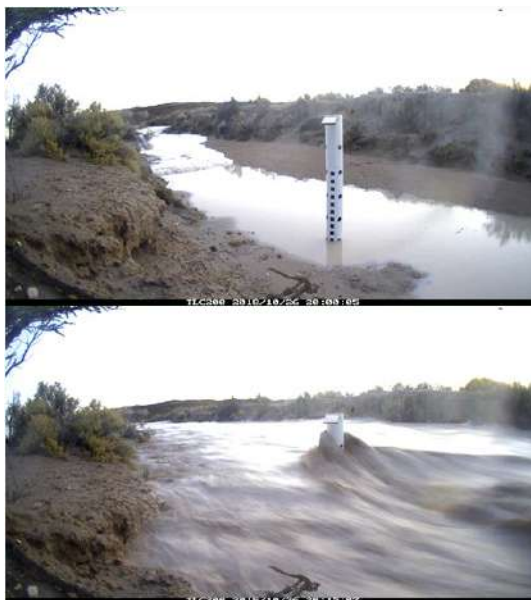
Figura 4: Secuencia fotográfica del paso de un evento. Estación de aforo de Charito mostrando el arribo de la crecida a las 20:00 y el nivel máximo 15 minutos después (evento del 26/10/2018).
