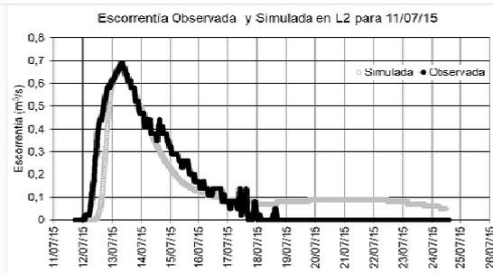
Figuras 25 y 26: De izquierda a derecha, comparación de la escorrentía observada y simulada para las estaciones limnigráfica L1 y L2 para la tormenta del 11/07/15.
