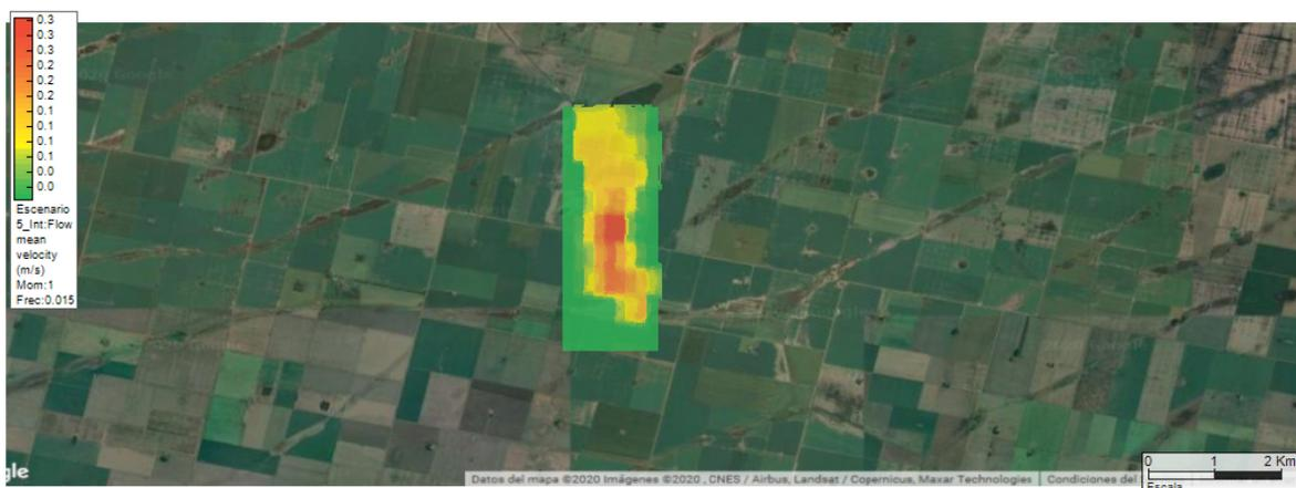
Figura 7. Velocidades medias (m/s).Modulo ERN-Inundación Escenario 5 (de 68626 m a 65850 m).
