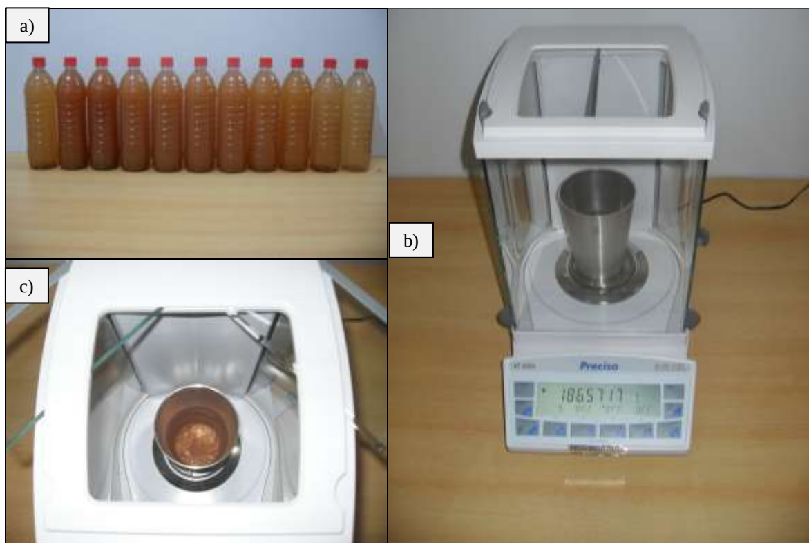
Figura 6.a) Muestras de agua recogidas durante la tormenta del 19-nov-2013; b) Submuestra de agua en balanza de precisión; c) Submuestra ya secada.
