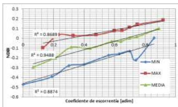
Figura 7. Relación Coeficiente de escorrentía C, índice NDBI para la imagen del 15/01/2014. Valores máximo, mínimo y media aritmética representados para cada una de las 9 clases.
