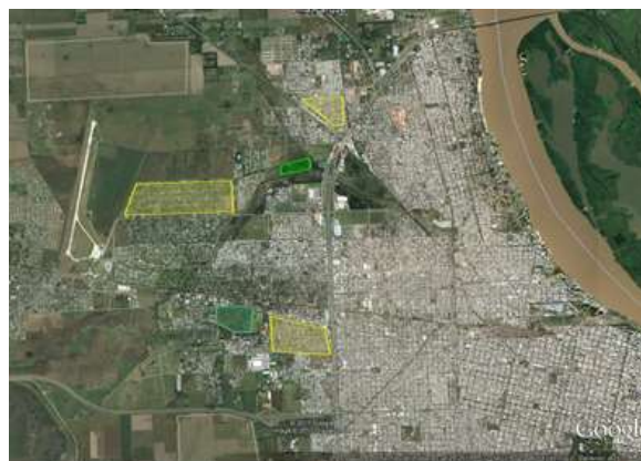
Figura 6. Ejemplo de algunos de los polígonos utilizados para la regresión lineal coeficiente C, índice de construcción.
