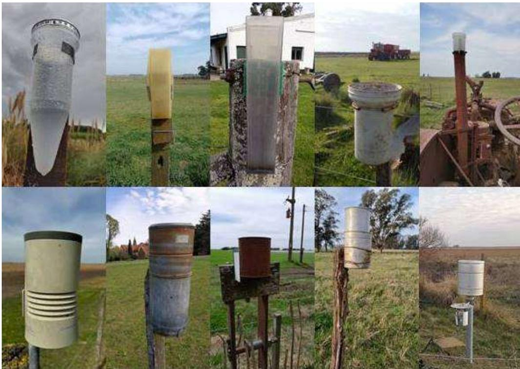
**Figura 2.** Muestra de los diferentes diseños de pluviómetros utilizados por los miembros informantes.
