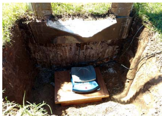
Figura 6. Instrumentación del ensayo y parafinado de la cara libre.
