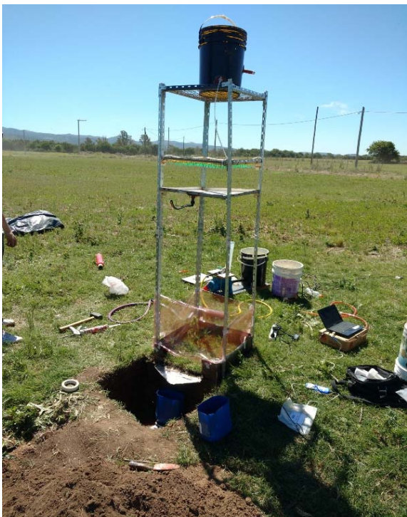
Figura 3. Simulador de lluvia Tipo B instalado en campo.
